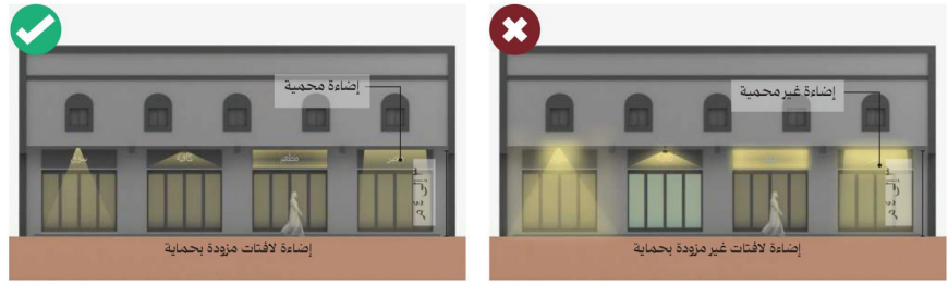
الشكل ١٠: يجب أن تمشي إضاءة المباني التجارية مع متطلبات الحماية من وهج الإضاءة لجميع تركيبات إضاءة الواجهات وإضاءة الالافات
